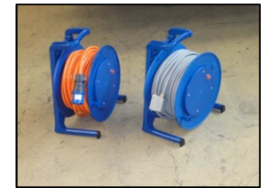
Steuerkabel auf Rollen
