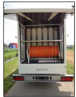
Kabeltrommel und Steckdosen
